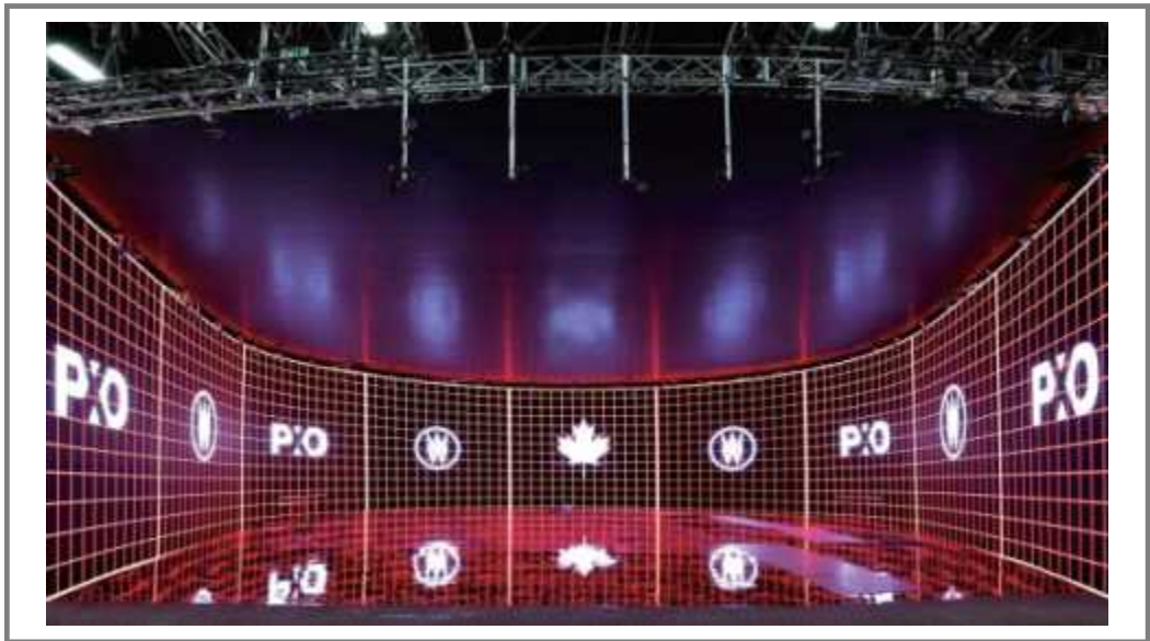
[그림 2-2-65] 픽소몬도의 버추얼 프로덕션 스튜디오에 설치된 LED 월
