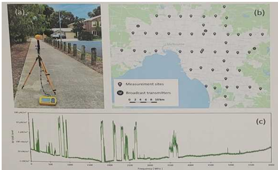
< 측정장비(a), 측정지점(b) 및 주요대역의 측정값 예시(c) >
