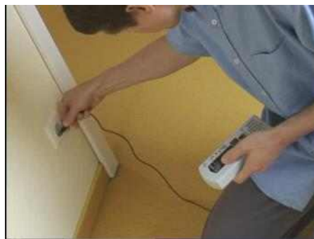
[그림 4-4] Grounding the AC electric field meter
