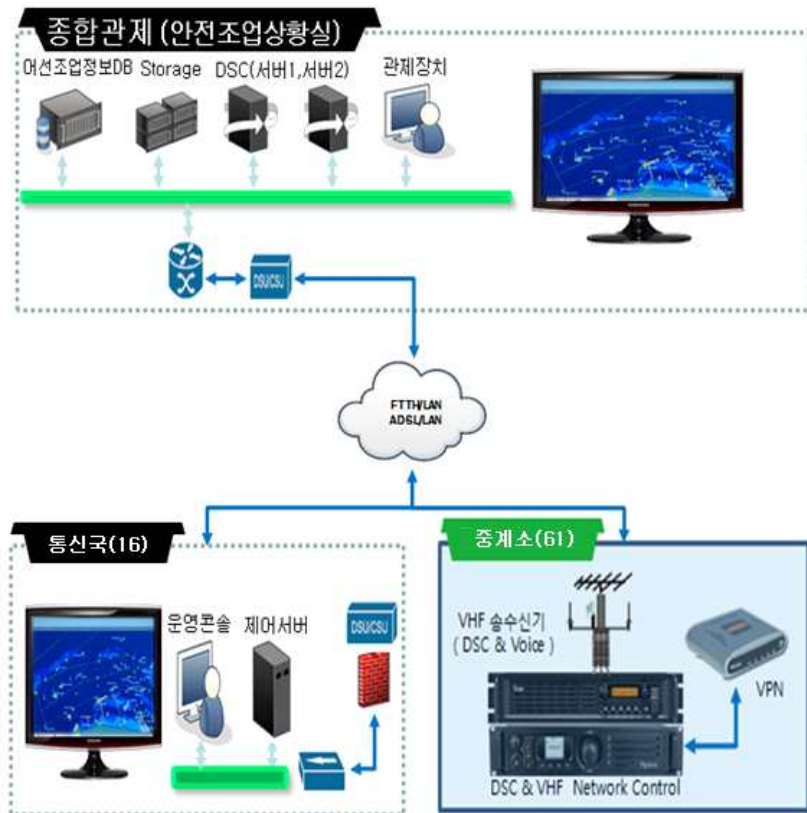
<그림 2.10> 어업정보통신국의 VHF-DSC 시스템 구성도
