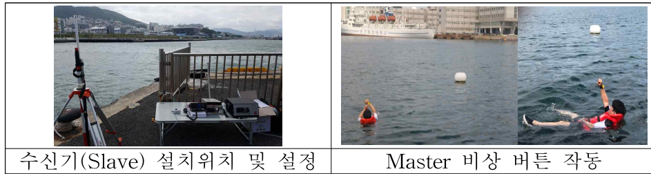
<그림 4> 선외추락경보장치 시제품 해상환경 통신 실험
