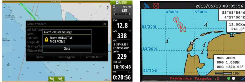
<그림 4.3> AIS 선외추락 경보장치 작동 시 AIS 전자해도 상의 수신 화면
