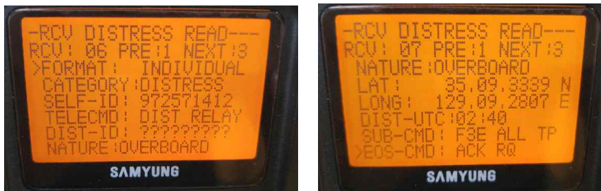
<그림 4.5> DSC 선외추락 경보장치 신호의 VHF 무선설비 수신 화면
