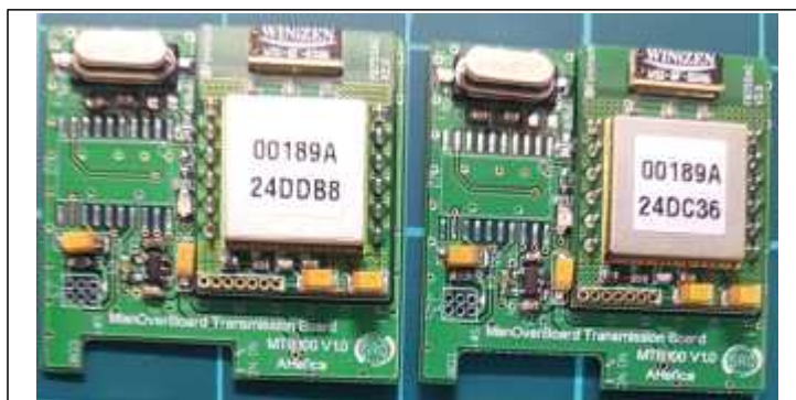
<그림 6.18> 송신기 모듈 PCB 제작
