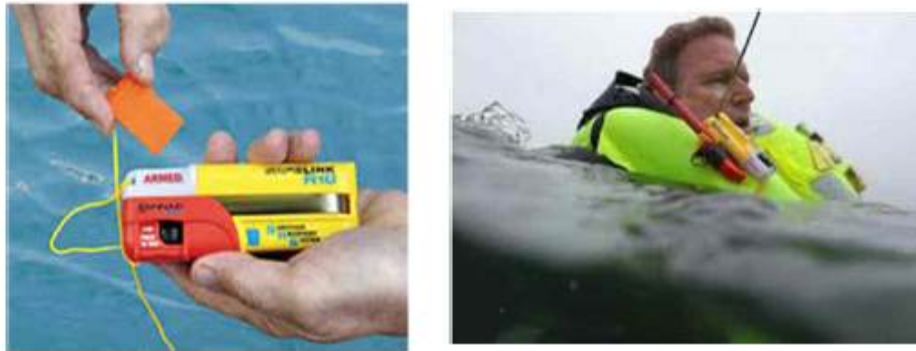
<그림 4.2> AIS 선외추락 경보장치 작동 예시
