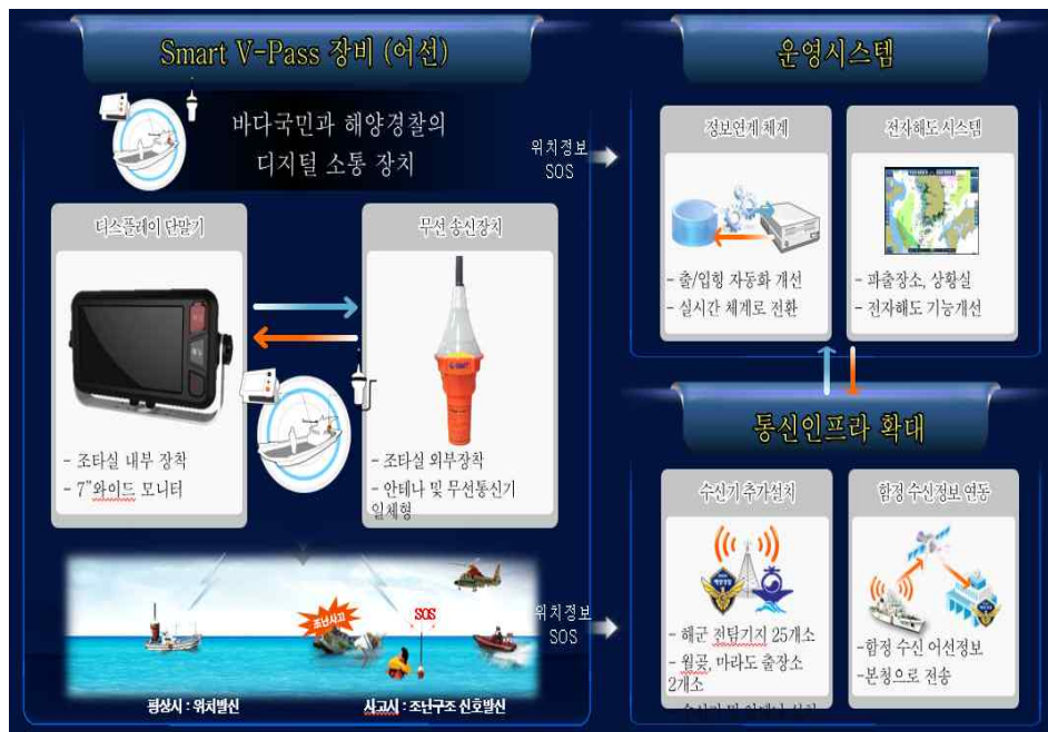
<그림 2.12> 해양경찰 V-Pass 시스템 구성도
