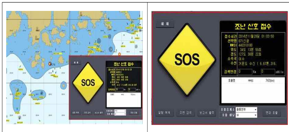
<그림 2.11> 어업정보통신국의 VHF-DSC 시스템의 수신된 조난 메시지
