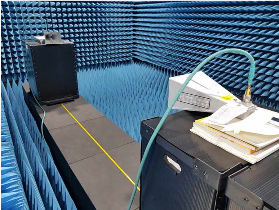
그림 4.7 안테나를 이용한 3.5 GHz 실내 측정 환경
