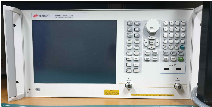
그림 3.10. 측정에 사용된 2 port Network Analyzer(E5063A)
