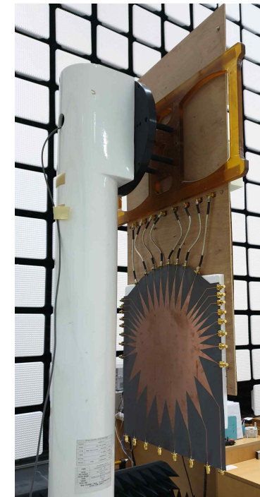
그림 3.21. 배열 패치 안테나 후면에 결선한 로트만렌즈 형상
