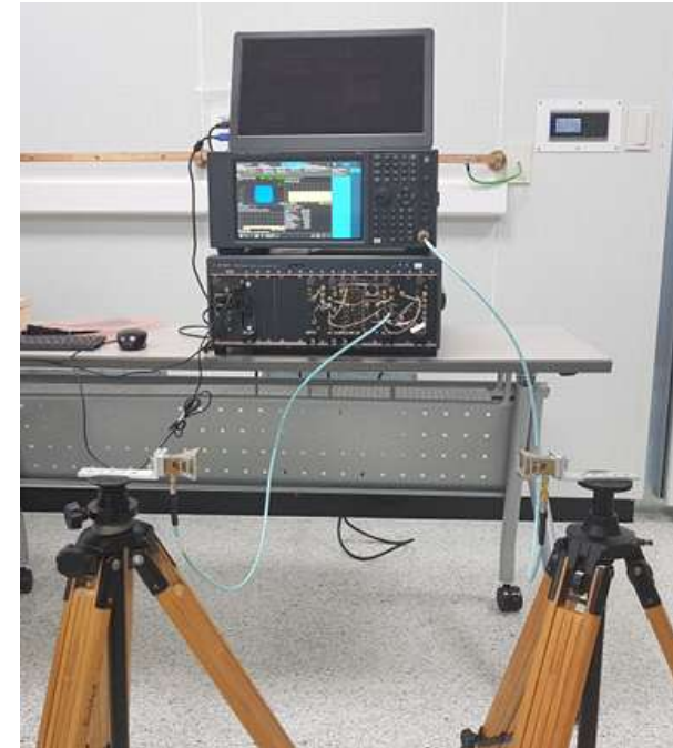
그림 4.20 안테나를 이용한 28 GHz 0.4m 실내 측정 환경
