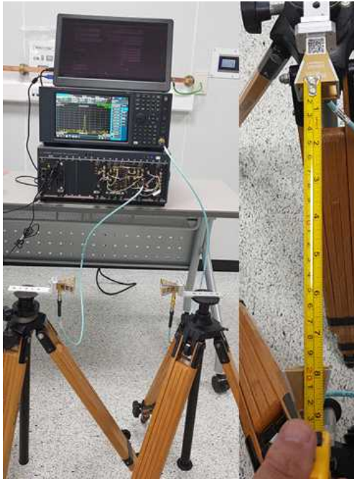
그림 4.16 안테나를 이용한 28 GHz 0.2m 실내 측정 환경
