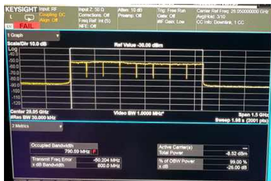
그림 4.14 반송주파수 28 GHz 8개 캐리어의 occupied bandwidth 측정 결과
