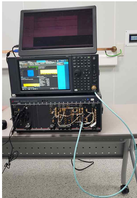
그림 4.10 28 GHz 신호 측정 시스템
