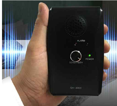
(그림 2.7) 15.75 kHz를 탐지하는 휴대형 감지기 (출처: 바른정보통신)
