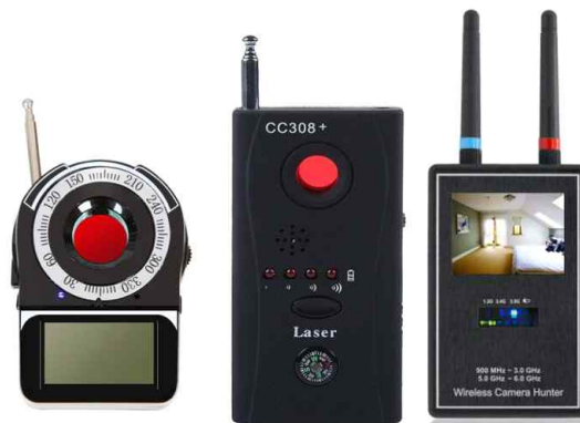
(그림 2.2) 전파강도를 탐지하는 전파탐지 방식의 휴대용 변형카메라 탐지기
