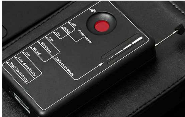
(그림 2.8) 실시간으로 영상을 송출하는 카메라의 무선송신주파수를 탐지하는 휴대형 감지기 (출처: LawMate, Taiwan)
