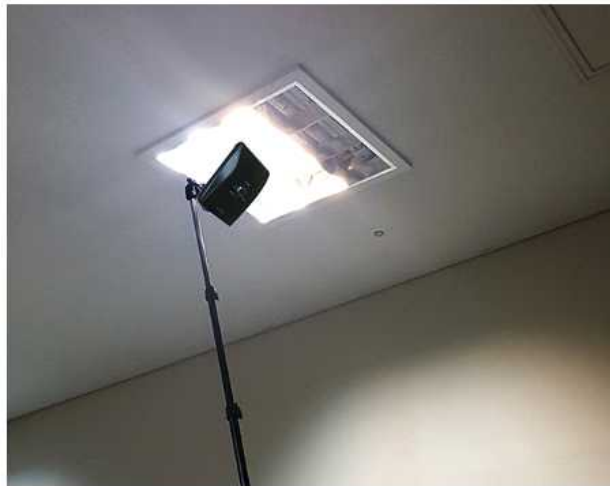
(그림 2.3) 와이파이 등 통신 트래픽 신호를 추적한 전파탐지 방식의 변형카메라 탐지기 운영형태 (출처: 바른정보통신)
