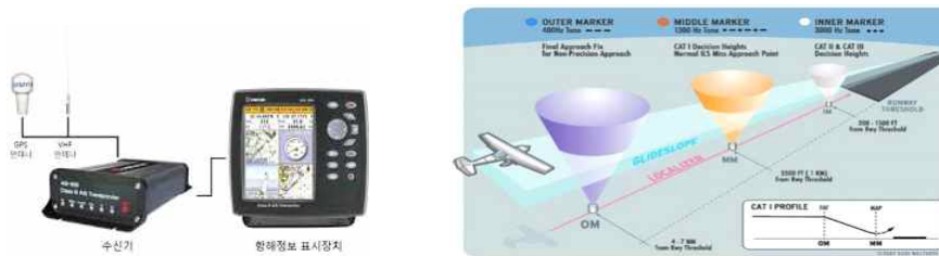
[그림 2.1.17.] VHF 기기와 계기착륙장치(ILS)
