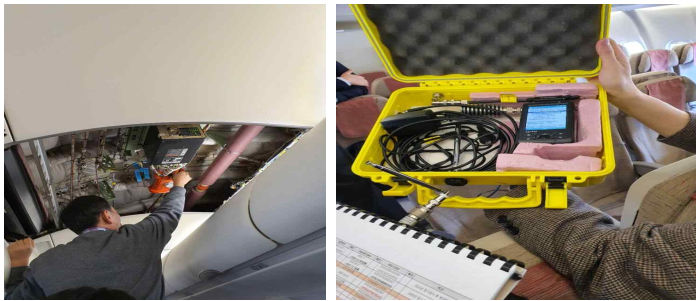
[그림 4.2.3.] 항공기 내부의 ELT 시험검사 과정
