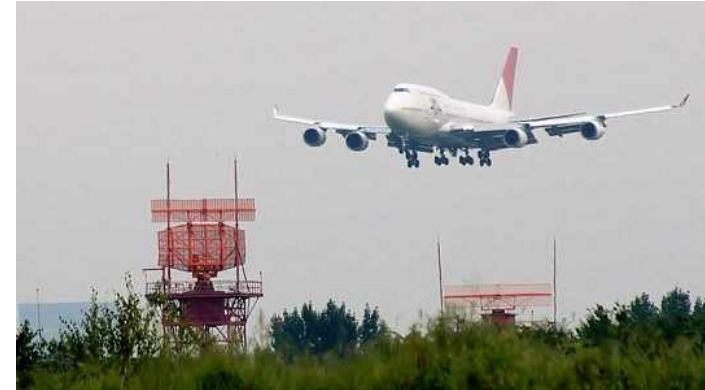
[그림 3.4.1] 공항 감시 레이더 (아래쪽 둥근모양이 1차감시레이더(ASR)이고, 위쪽이 2차 감시레이더임(SSR))(출처: https://m.blog.naver.com/1 )
