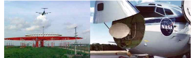
[그림 2.1.18.] VOR 및 기상 레이더 사용 과정과 실제 모습
