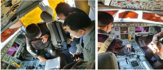
[그림 4.2.2.] HF, VHF 등 무선송신기 장치 시험 검사 진행 사진촬영
