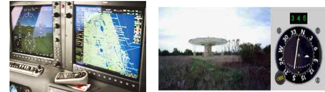
[그림 2.1.14.] 항공기내 조종석 모니터 및 VOR 지상장비 및 항공기 탑재장비
