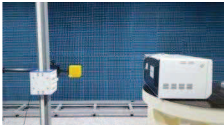
전자파 차단 임부복 미거치 60 Hz 자기장 측정구성(EHP-50)
