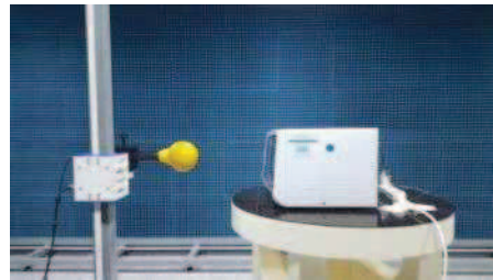
콘센트형 전자파 차단필터 적용 2.4 GHz 전기장 측정구성(SRM-3000)
