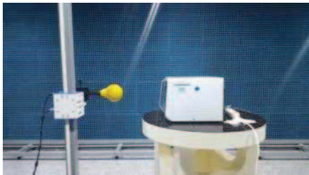
콘센트형 전자파 차단필터 미적용 2.4 GHz 전기장 측정구성(SRM-3000)
