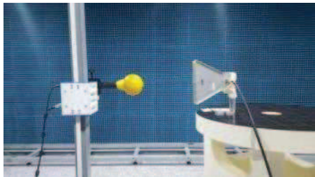
전자파 차단 공기청정기 미적용 2.4 GHz 전기장 측정구성(SRM-3000)
