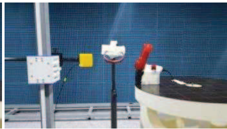
전자파 차단 공기청정기 적용 60 Hz 전기장 측정구성(EHP-50)
