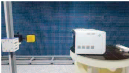
전자파 차단 공기청정기 미적용 60 Hz 전기장 측정구성(EHP-50)
