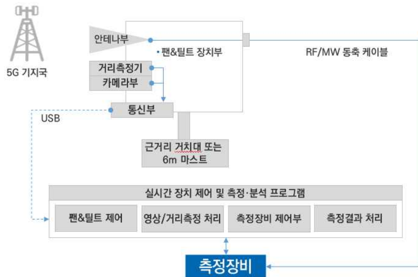
<그림 5-20> 5G 기지국 OTA 측정 도구 구조
