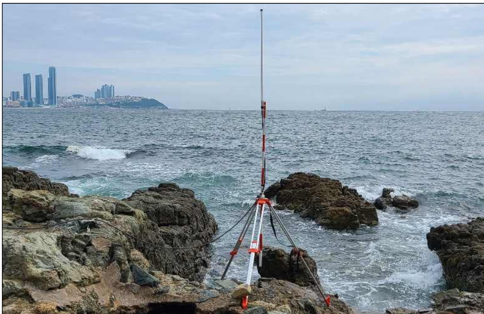
[그림 4-45] 고정 수신안테나 설치 현황
