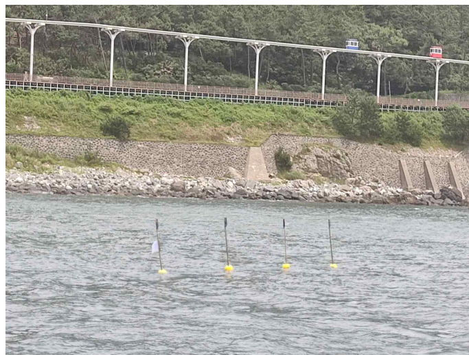
[그림 4-38] 해수면 1m 높이에 송신기 고정 부표 설치
