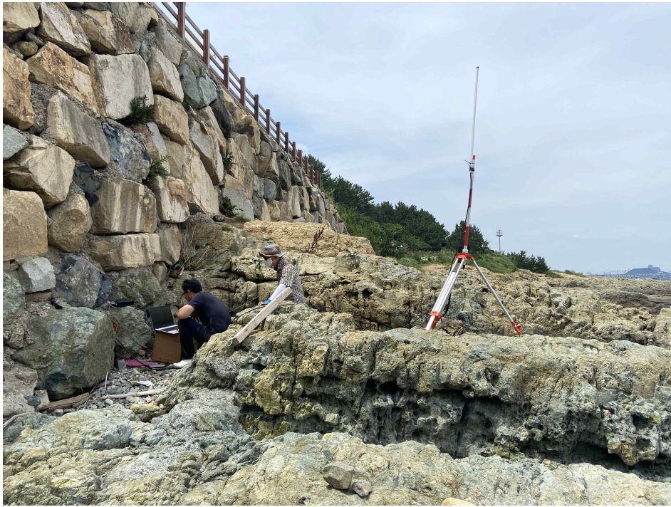
[그림 4-41] 송신기에서 6.1km 떨어진 위치에서 수면 4m 높이 수신기 설치
