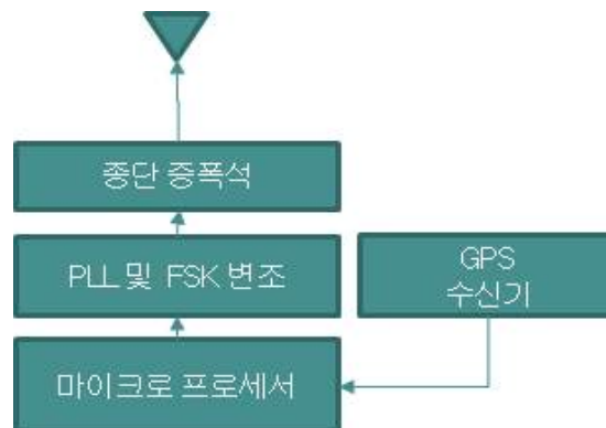
[그림 3-11] AMRD 송신기 블록도
