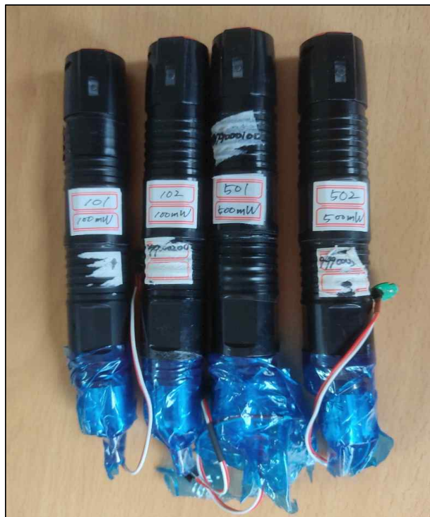
[그림 4-43] 측정 시험용 AMRD 송신기
