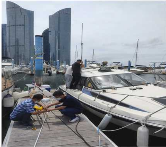
[그림 4-39] 요트에 수면 4m 높이 수신기 설치
