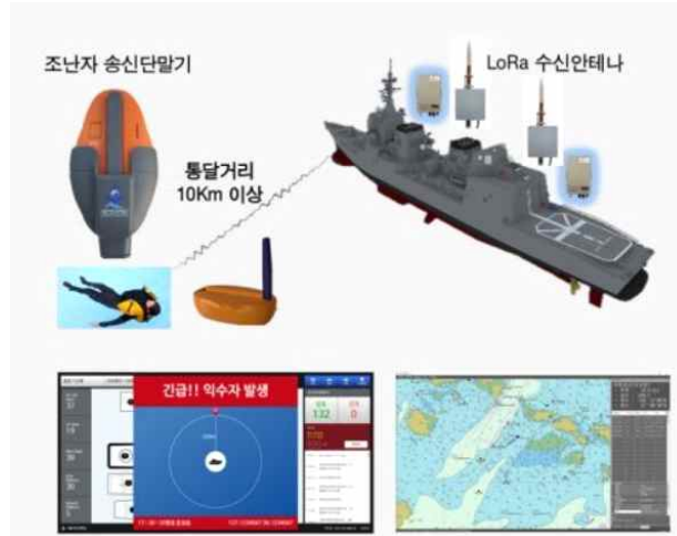
[그림 2-3] LoRa 기반 MOB 장치
