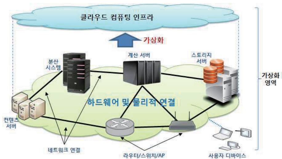
[그림 2] 클라우드 컴퓨팅을 위한 하드웨어 연결과 가상화의 예시
