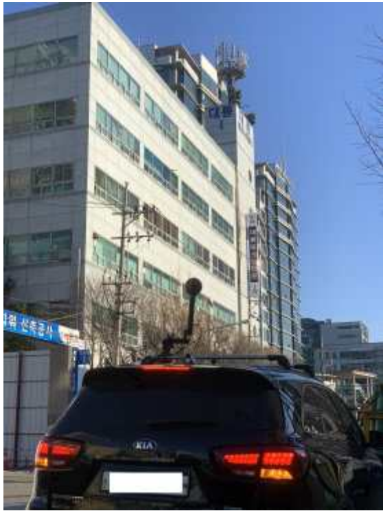
< 비대면 전자파 측정 장면 - 이동형 5G 전자파 강도 측정시스템 >
