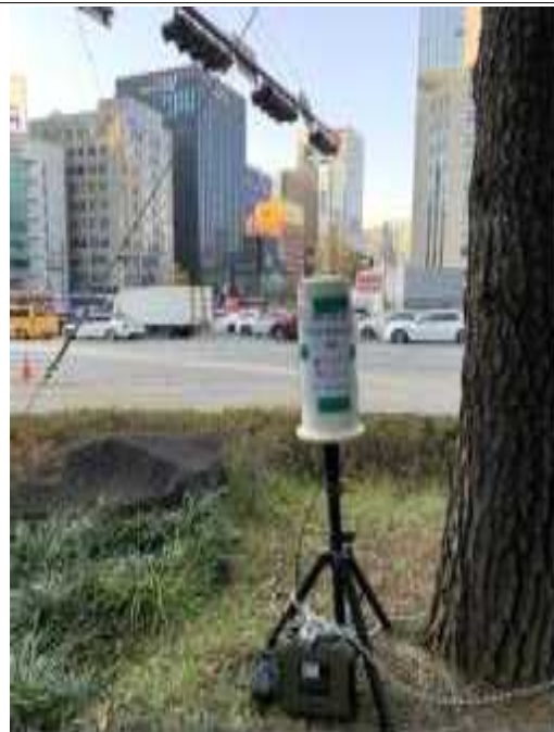
< 비대면 전자파 측정 장면 - 무인원격 전자파 모니터링 측정시스템 >
