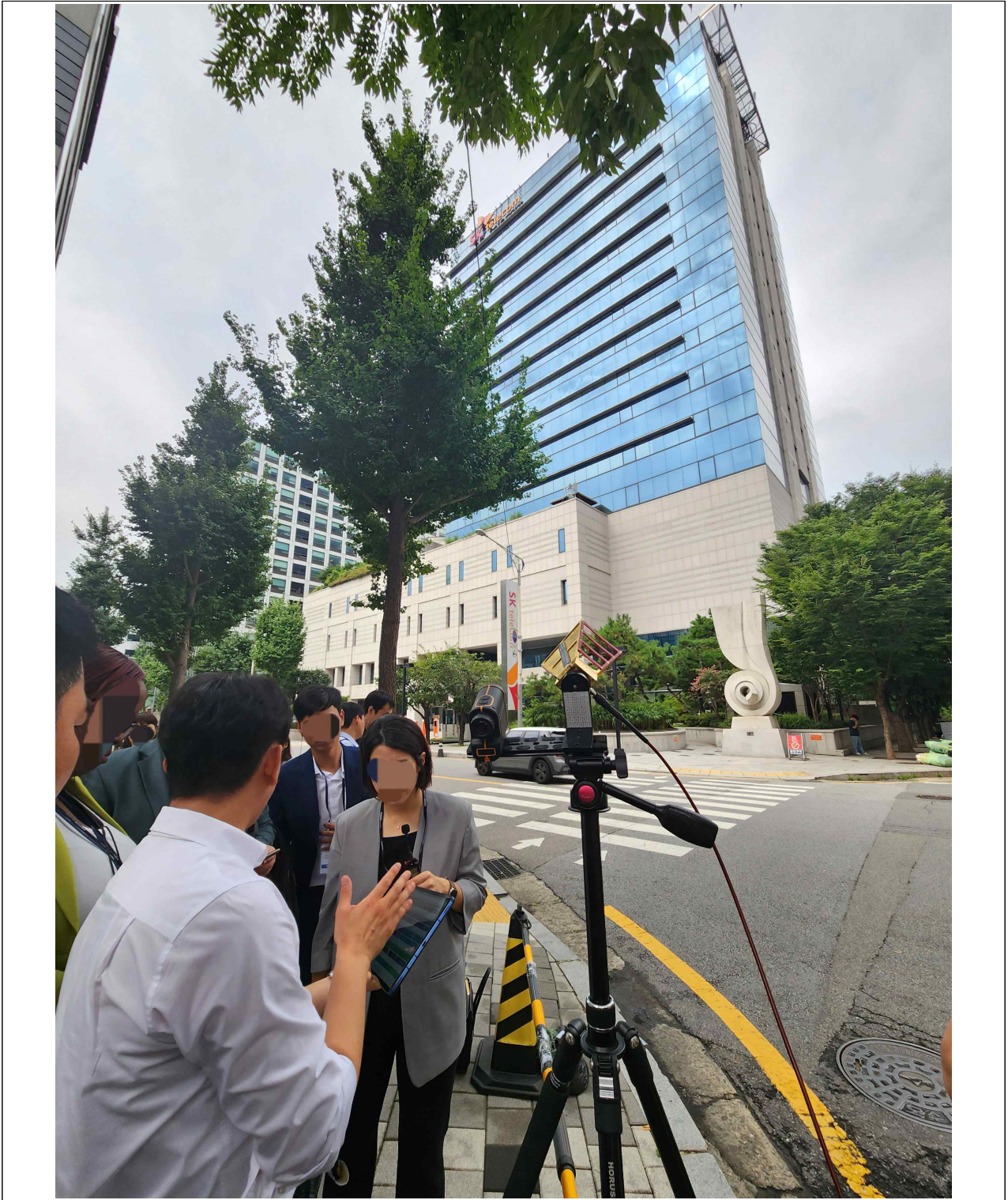
[사진] KCA 무선국 검사관이 5G 기지국 측정 시연하는 모습
